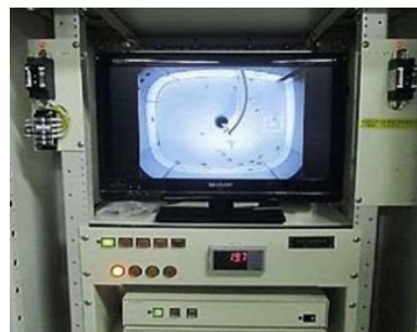
ヒメダカによる水質監視装置
