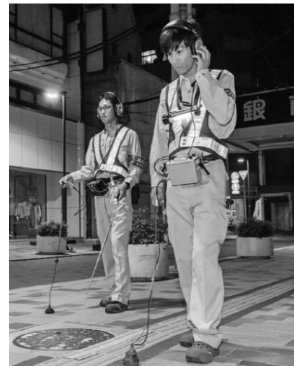
管路の漏水調査
