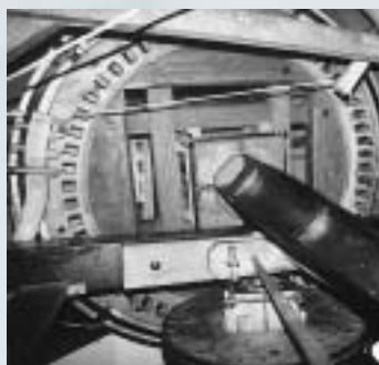
①ウィンドシャフトフロア 羽根が受けた風の力を、石うすにつながる主軸に伝えます
