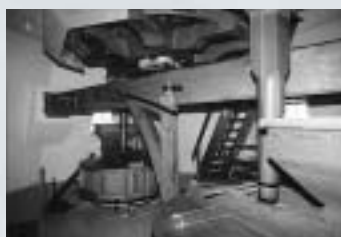
③スパーウィルフロア 穀物を粉にする粉ひき部屋で、直径約1.5mの石うすが2基あります
