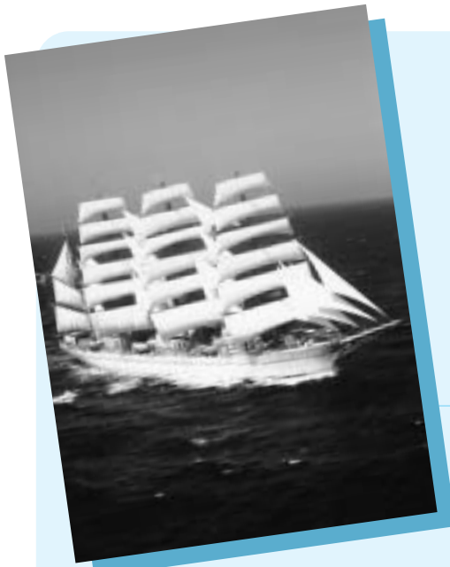
全長約110m、幅約13.8m、深さ約10.7mで4本のマストをもち、横帆・縦帆各18枚で、メインマストの高さは海上約50mにもなります。
