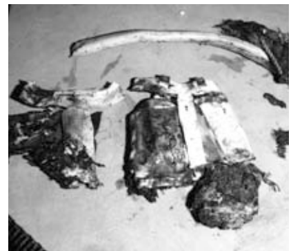
過去に施設で発火したごみの中から見つかった電池
