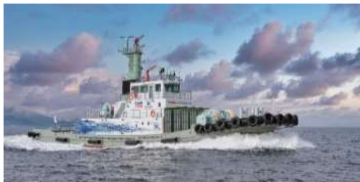
図 22 水素混焼エンジン搭載型タグボート
