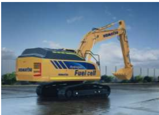
図 15 燃料電池を搭載した中型油圧ショベル (コンセプトマシン) (出典 : 小松製作所ホームページ)
