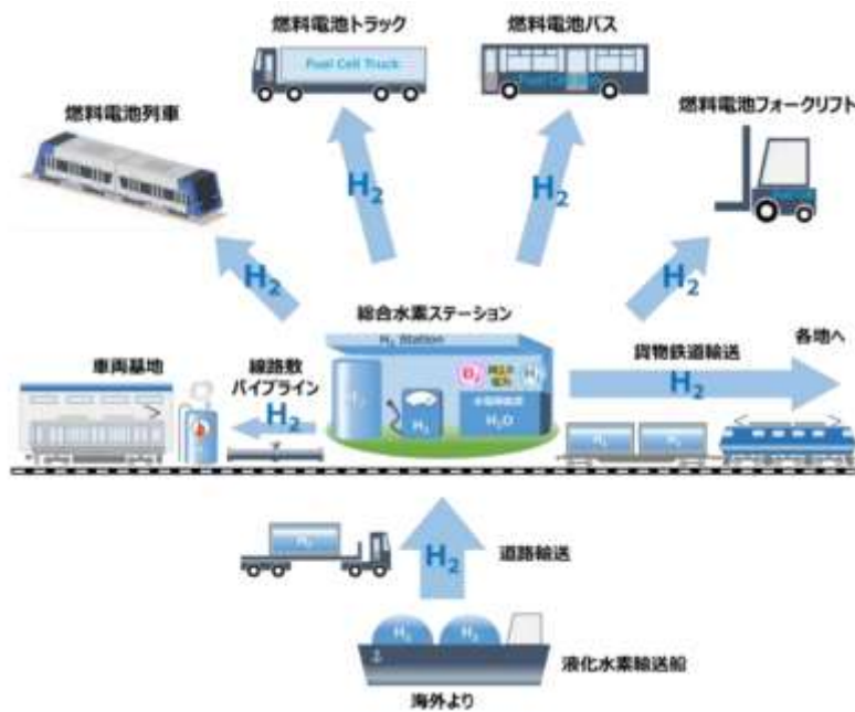
図 18 多様なモビリティへの水素供給を行う総合水素ステーションのイメージ (出典：鉄道アセット活用における水素利活用の検討開始について JR 西日本グループ)
