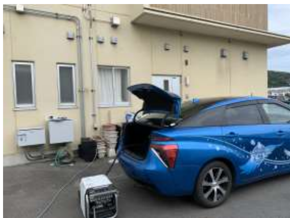
図 17 周南市櫛浜市民センターに整備した給電設備と燃料電池自動車からの給電状況
