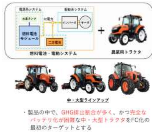
図 14 燃料電池搭載農業用トラクタの実証研究
