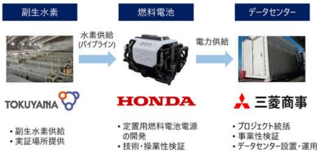
図 19 副生水素と車両からのリユースを想定した定置用燃料電池電源のデータセンター向け実証のイメージ (出典：三菱商事株式会社ホームページ)
