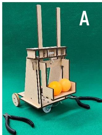
フォークリフトの仕組みを使用したピンポン玉回収ロボットです！
