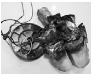
過去に施設で発火したごみ ▶ の中から見つかった電池
