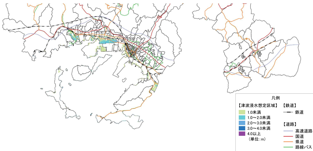
図 2-32 津波浸水想定区域（沿岸部）
