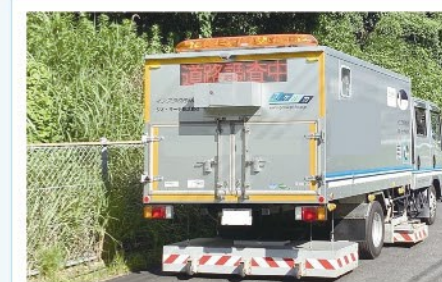
道路陥没を未然に防止するための空洞調査を実施している様子
