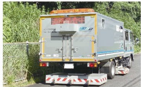
道路陥没を未然に防止するための 空洞調査を実施している様子
