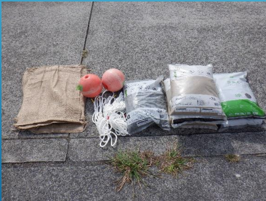
①使用器材(砂、腐葉土、碎石、麻袋、固定用ブロック・ロープ、目印ブイ)
