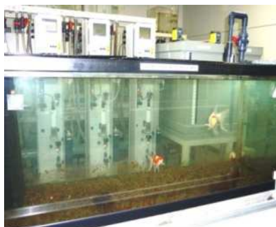
魚類監視装置（原水用）
