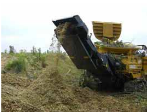
【破碎機によるチップ化】
