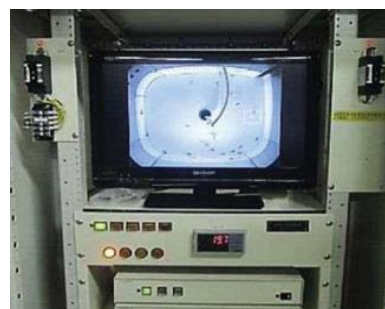
ヒメダカによる水質監視装置
