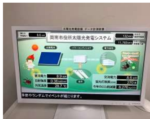
【発電量モニター】
