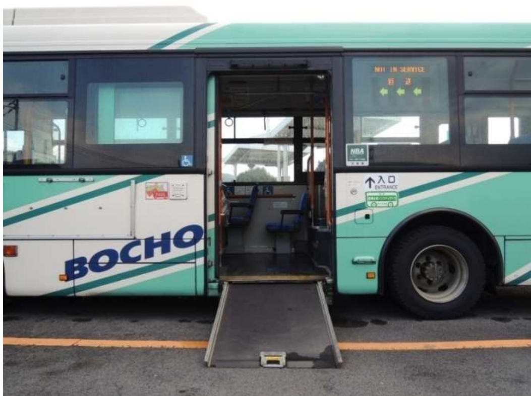
図 73 車両のバリアフリー化のイメージ（ノンステップ車両）
