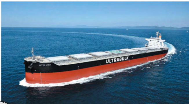
船名「ULTRA LYNX」・全長228.94m・型幅32.24m・型深20.00m・ さいかい 載貨重量81,607MT
